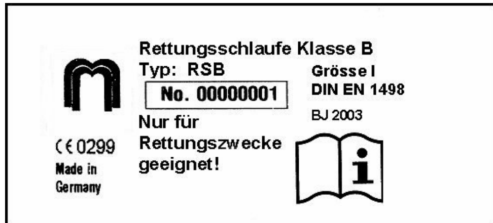
Bild 21: Muster der Kennzeichnung einer Rettungsschleufe
