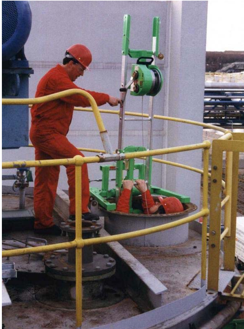
Bild 5: Rettungshubgerät der Klasse B
